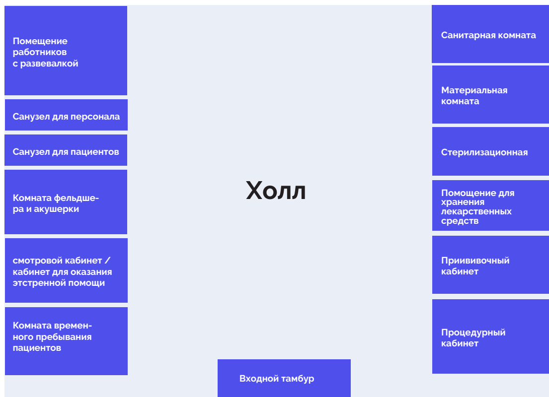
Рисунок 12 Блок-схема рекомендуемой структуры помещений ФАП с обслуживанием > 800 человек
